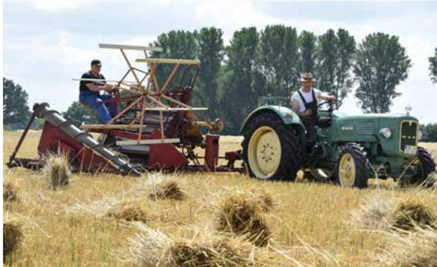
Wirkt wie eine Oldtimervorführung, ist aber echt: Lasse Seidler bedient den McCormick-Mähbinder, der die langen Stoppeln abschneidet; gezogen wird der Mähbinder von einem MAN-Schlepper mit Detlef Schulz am Lenkrad. Fotos: Lars Kuhlmann
